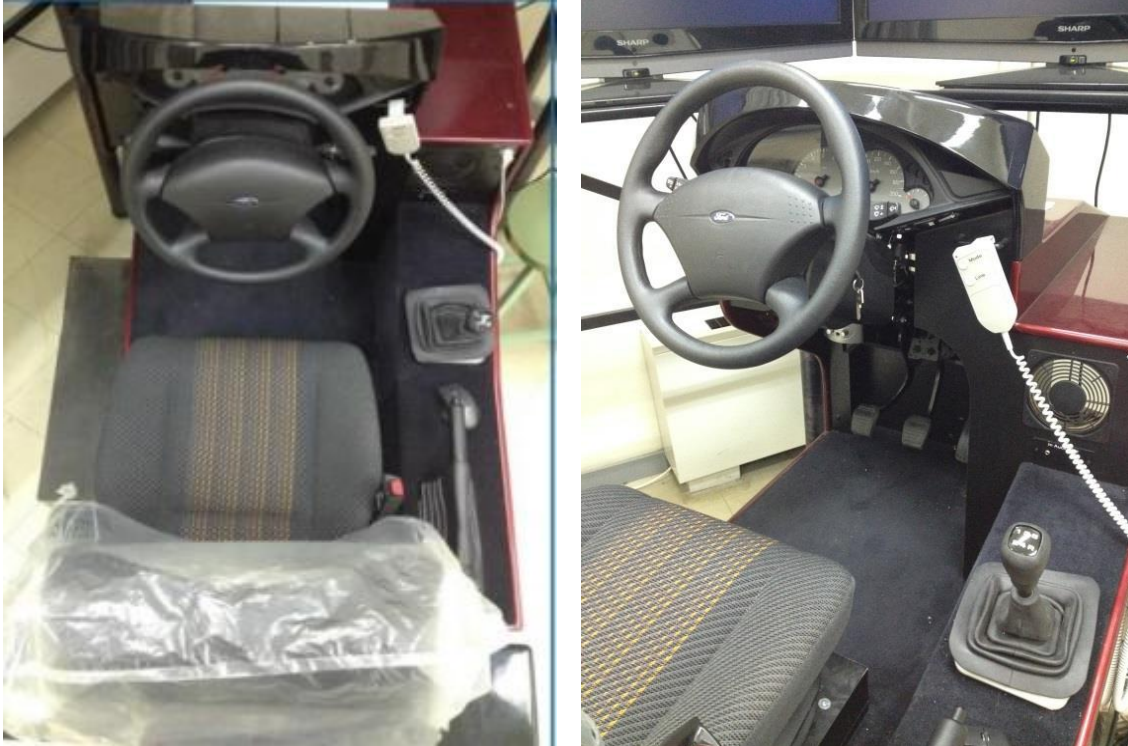
Εικόνες 4.2 , 4.3 : Φωτογραφίες της θέσης οδήγησης του προσομοιωτή οδήγησης
