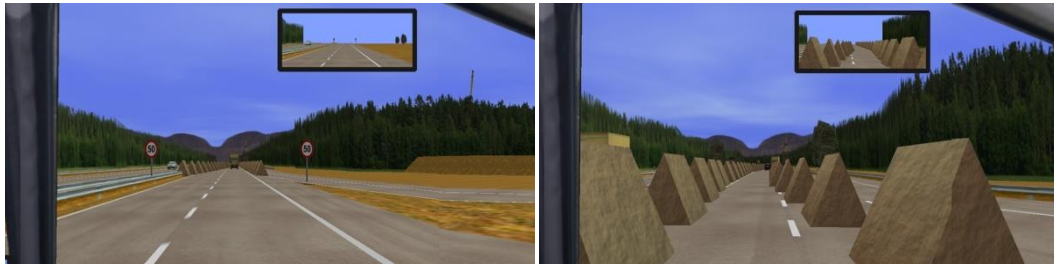
Σχήμα 2: Συνθήκες δοκιμασίας TC2 (α: αριστερά) με τη ζώνη έργων σε απόσταση; (β: δεξιά) τα εμπόδια περιορίζουν το πλάτος του οδοστρώματος
