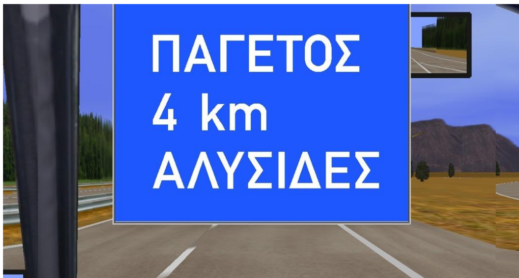
Σχήμα 1: Παράδειγμα μηνύματος σε πινακίδα προειδοποίησης με τρεις μονάδες πληροφοριών σχετικά με: (1) συνθήκες παγετού, (2) απόσταση (4km), και (3) απαιτούμενες ενέργειες (χρήση αλυσίδων)
