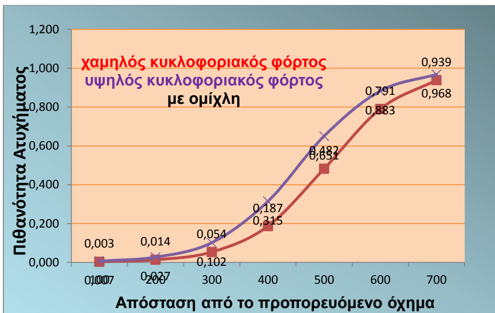
Διάγραμμα 5.17: Συσχέτιση της πιθανότητας να συμβεί ατύχημα με την απόσταση του οχήματος από το προπορευόμενο όχημα, σε διαδρομές με ομίχλη, για διαδρομές με υψηλό κυκλοφοριακό φόρτο και για διαδρομές με χαμηλό κυκλοφοριακό φόρτο.
