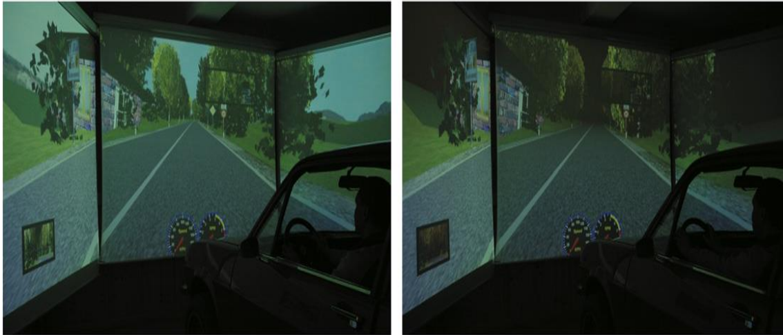
ΕΙΚΟΝΑ 2.1: Παράδειγμα από το περιβάλλον του προσομοιωτή οδήγησης την ημέρα (αριστερά) και τη νύχτα (δεξιά)
