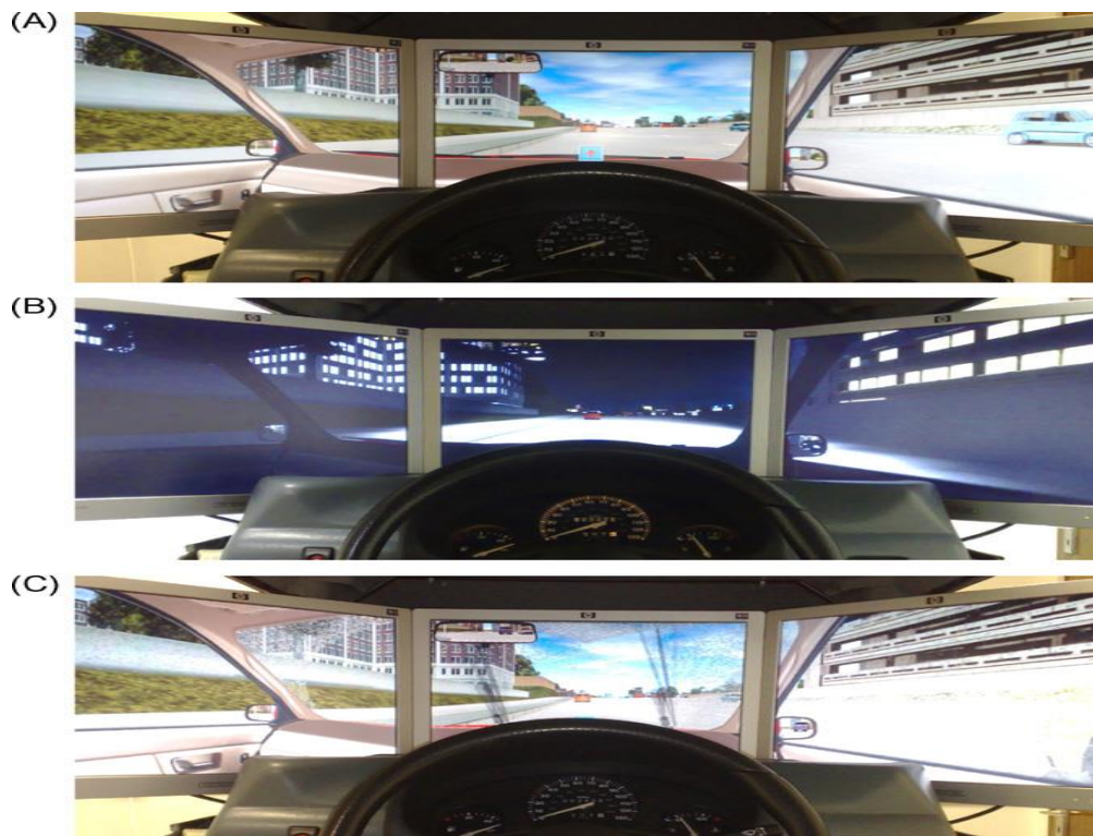
ΕΙΚΟΝΑ 2.2: Παράδειγμα από το περιβάλλον του προσομοιωτή οδήγησης την ημέρα, τη νύχτα και υπό συνθήκες βροχής
