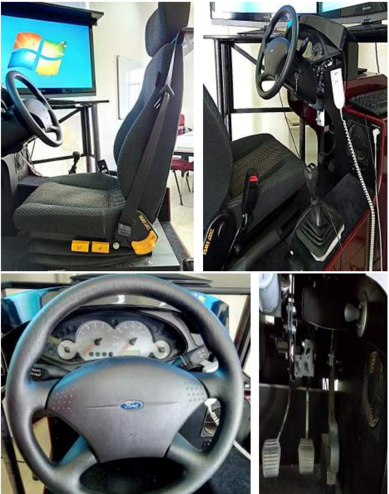
■ Εικόνα 4.2, 4.3, 4.4, 4.5: Φωτογραφίες της θέσης οδήγησης, του τιμονιού, των ποδόπληκτρων, του στροφόμετρου καθώς και του μοχλού ταχυτήτων του προσομοιωτή οδήγησης
