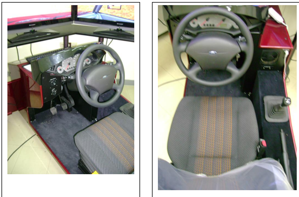
ΕΙΚΟΝΑ 4-2: Φωτογραφίες της θέσης οδήγησης του προσομοιωτή .
