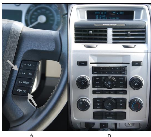
ΕΙΚΟΝΑ 2.2: Ειδικά συστήματα που χρησιμοποιήθηκαν εντός του οχήματος (Α:πλήκτρα στο τιμόνι Β: οθόνη επιλογής μηνυμάτων)
