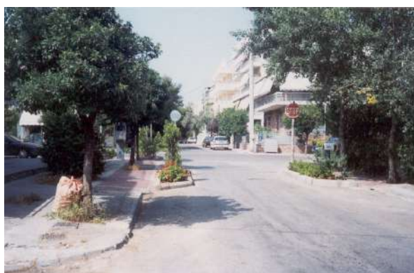
Εικόνα 5.5: Στένωση οδού στο Νέο Ψυχικό (Πηγή: προσωπικό αρχείο)
