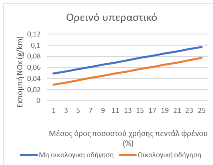
Διάγραμμα 5.5: Επιρροή του ποσοστού χρήσης πεντάλ φρένου κατά τη διάρκεια της οδήγησης σε ορεινό υπεραστικό δίκτυο με οικολογικό/μη οικολογικό τρόπο οδήγησης.
