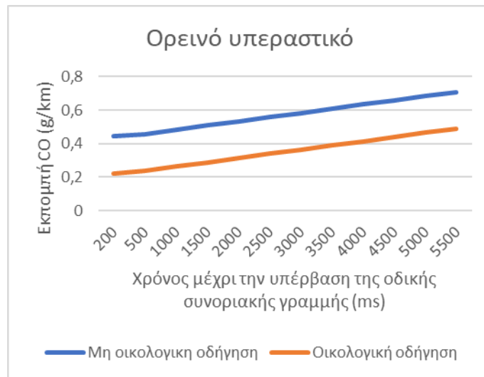
Διάγραμμα 5.1: Επιρροή του χρόνου μέχρι την υπέρβαση της συνοριακής γραμμής κατά τη διάρκεια της οδήγησης σε ορεινό υπεραστικό δίκτυο με οικολογικό/μη οικολογικό τρόπο οδήγησης
