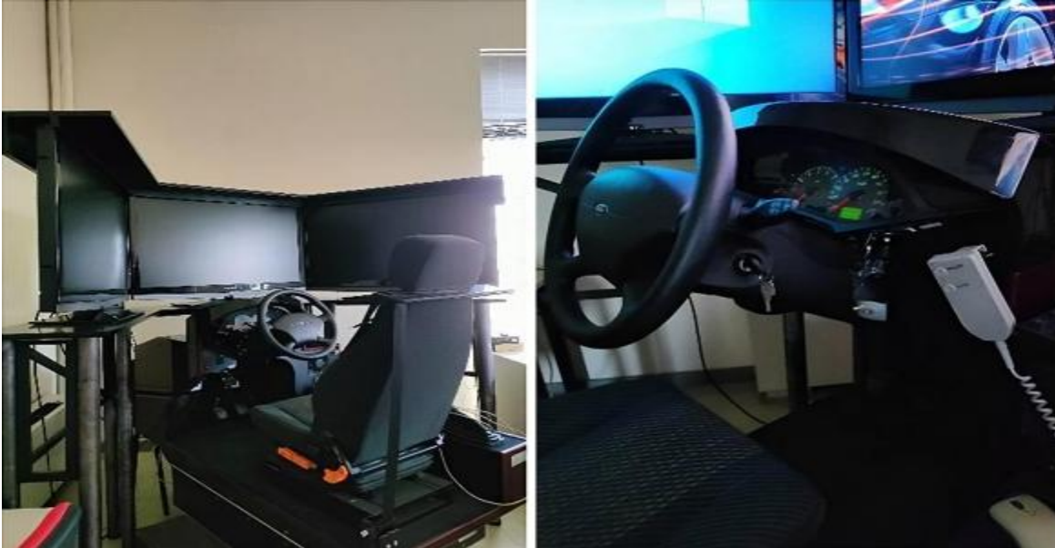
Εικόνα 4.1: Εξωτερικά χαρακτηριστικά προσομοιωτή οδήγησης
