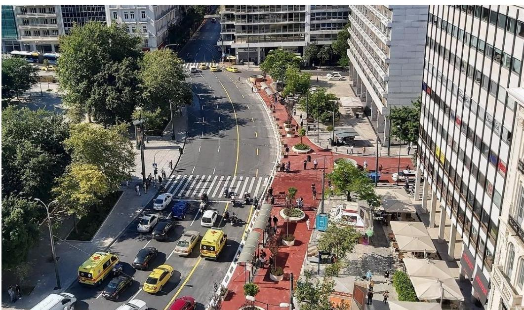
**Εικόνα 5.4** Η διαμόρφωση της Φιλελλήνων στο ύψος της πλατείας Συντάγματος κατά τη διάρκεια των πιλοτικών ρυθμίσεων του Μεγάλου Περιπάτου, με 2 λωρίδες κυκλοφορίας για όλα τα οχήματα και 1 λωρίδα κυκλοφορίας για τις δημόσιες συγκοινωνίες (Πηγή: fimotro.gr)
