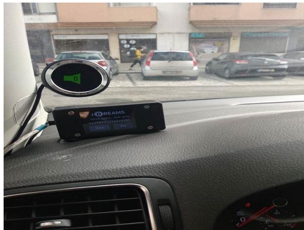
Εικόνα 2: Εξοπλισμός ανατροφοδότησης πληροφοριών σε πραγματικό χρόνο στο παρμπρίζ του αυτοκινήτου
